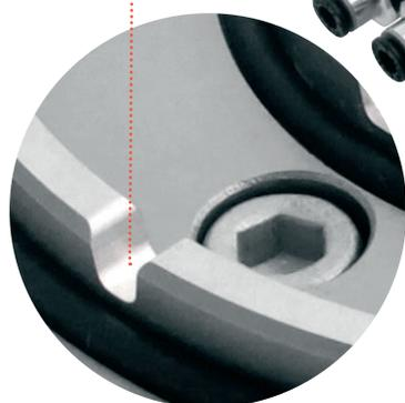
Corpo mandrino temprato con prismi per centraggio X/Y realizzato in un unico blocco per la massima stabilità. Indicizzazione 4 x 90°.
