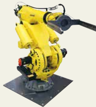
Automation - mit 6-achsigem Fanuc-Industrieroboter
